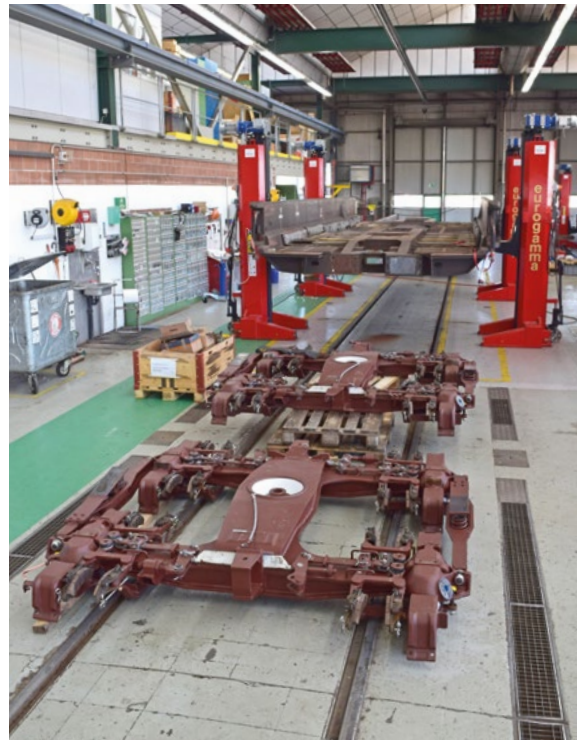
In der Instandhaltungswerkstatt Lonay/VD wird gerade ein Niederflur-Spezialgüterwagen revisioniert.
