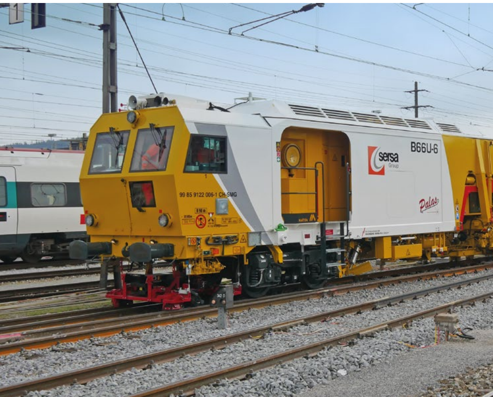
All-in-one: Die B66U-6 schafft Einmessen, Stopfen, Verdichten und Planieren in einem Arbeitsgang.
