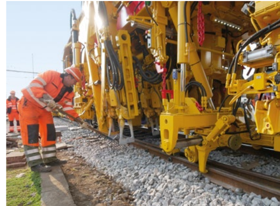
All-in-one: Die B66U-6 schafft Einmessen, Stopfen, Verdichten und Planieren in einem Arbeitsgang.
