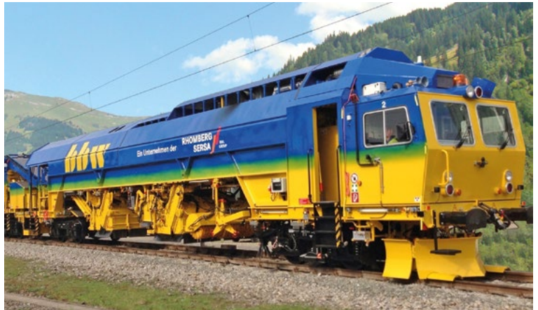
Das neue Schotterbewirtschaftungssystem BDS 2000-4 der BBW.
