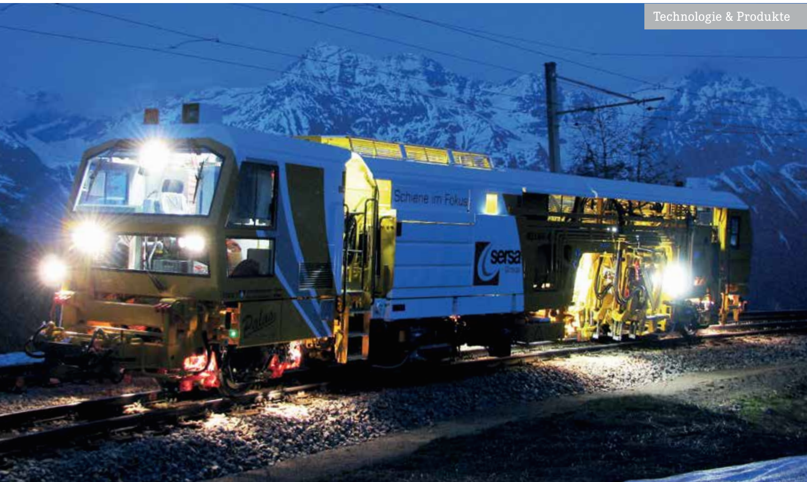
Die Stopfmaschine der Sersa Maschinerie Gleisbau AG ist in der Lage, Netzdaten zu erheben.
