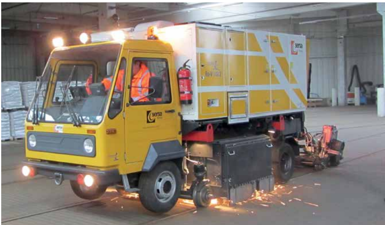
Die Maschine wurde speziell für Nahverkehrsbetriebe kreiert. Sie hält Lärm- und Staubemissionen äusserst gering und lässt sich innerhalb weniger Minuten ein- oder ausgleisen.
