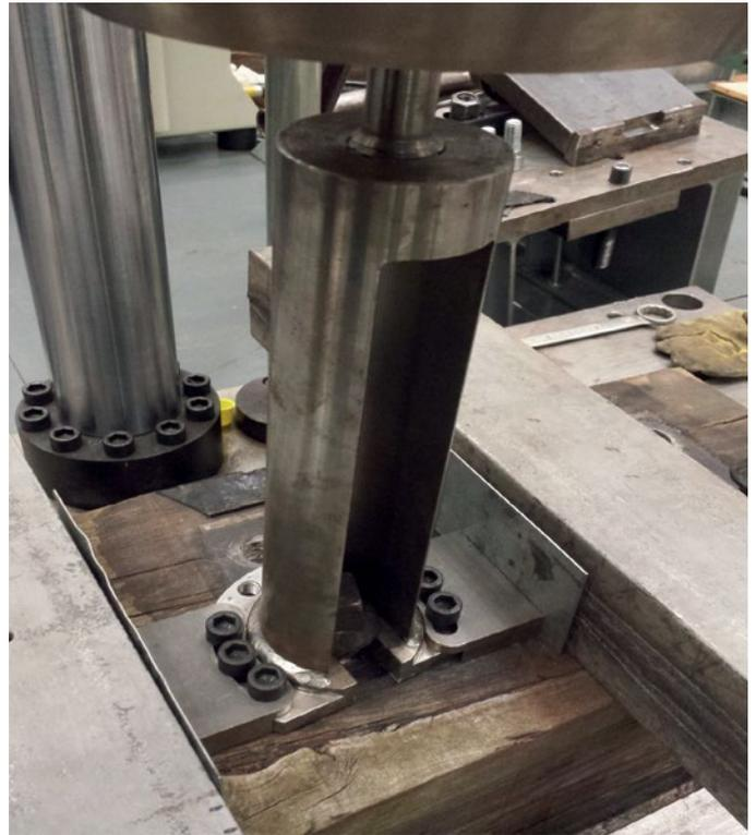
Abb. 6b: Ausziehversuch an der TU Dresden [1] Quelle: W. Fengler
