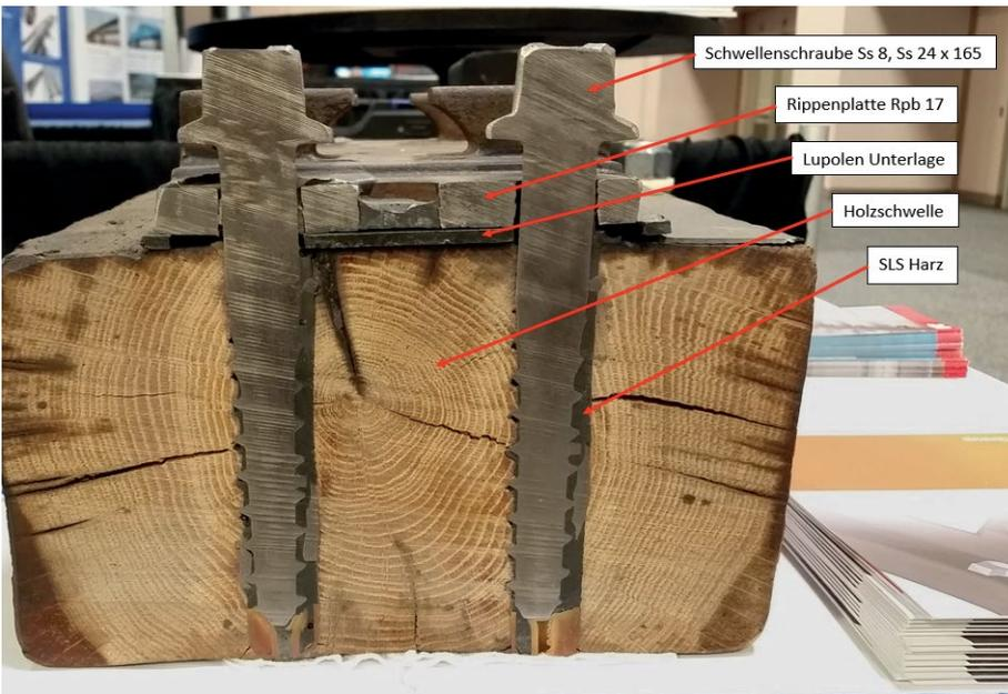
Abb. 4: Schnitt durch zwei sanierte Schraubenlöcher einer Holzschwelle
