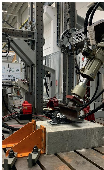
Abb. 5a, 5b: Eingespanntes FF-System IVES bei den Prüfungen an der TU Dresden
