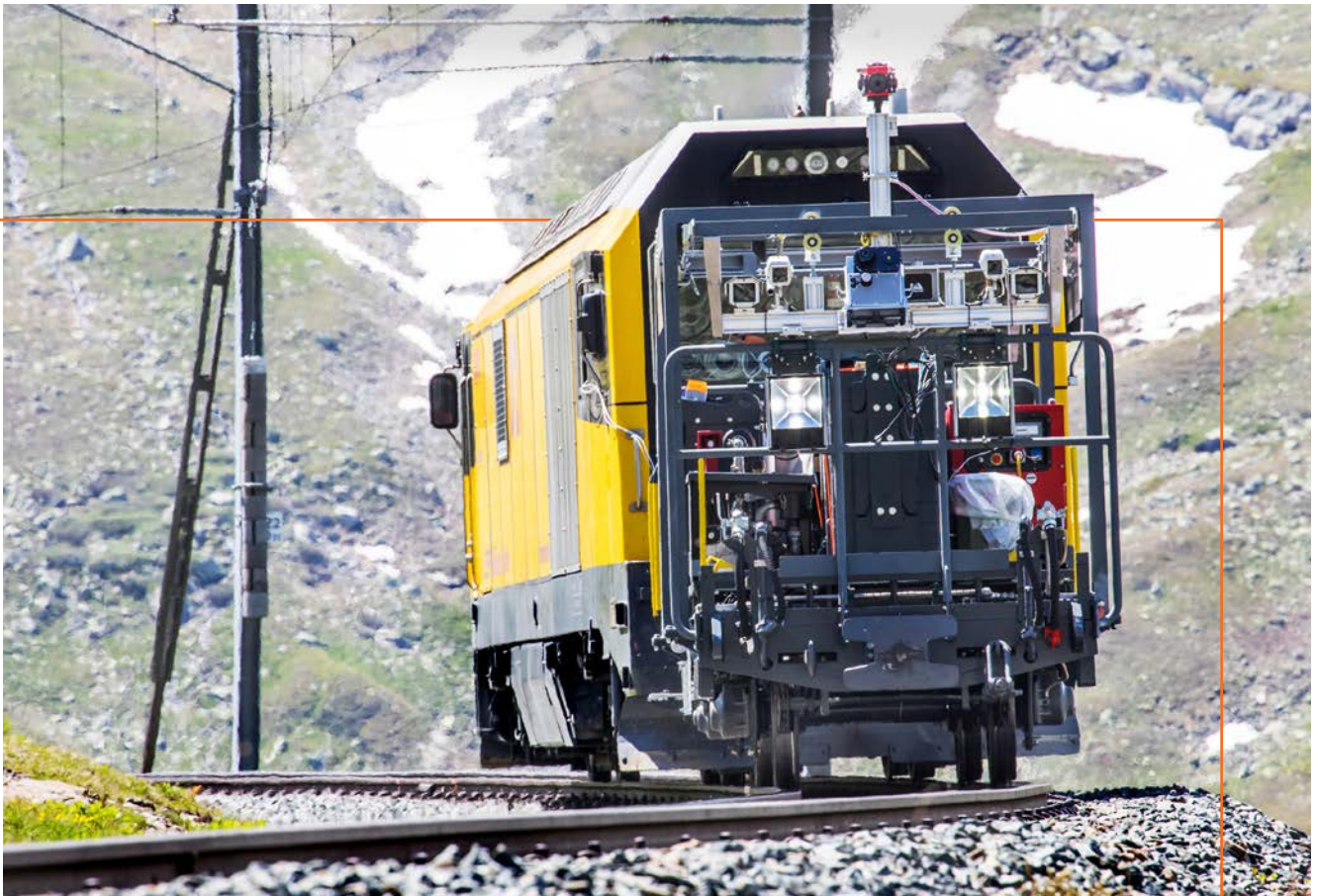
Prototyp eines Messwagens, auf dem eine Cloudlösung, eine Mobilfunkanbindung und vieles mehr verbaut sind.
